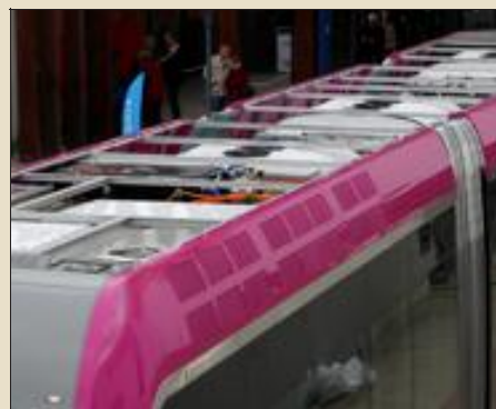
Les batteries sont situées sur le toit. Elles sont sollicitées au démarrage. Photo Gilles WIRTZ
